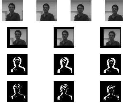
Figura 3.1: Sequência de imagens capturadas durante o seguimento. A linha de cima mostra as imagens originais, a segunda linha as imagens depois da compensação do movimento auto-induzido, a terceira linha o conjunto de pontos na imagem onde ocorreu movimento independente e a quarta linha os pontos considerados para estimar a posição do alvo na imagem
