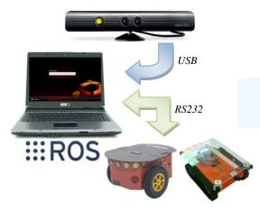
ambiente, possibilitando a representação volumétrica do ambiente, a navegação do robô e o reconhecimento de silhuetas humanas. O *Kinect* possui também acelerómetros, um servomotor e um *array* de quatro microfones.
